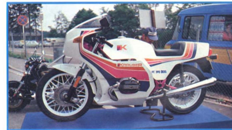
En avant première du Salon de Cologne la BMW Krauser. Le moteur est celui de la 100RS en attendant une version à quatre soupapes par cylindre. La partie cycle en tubes treillis est surmontée d'un réservoir aluminium qui lui-même est recouvert d'un ensemble plastique. Guidon bracelet, commandes reculées finissent le caractère résolument café racer de cette BMW qui est par ailleurs plus légère que la version standard.
