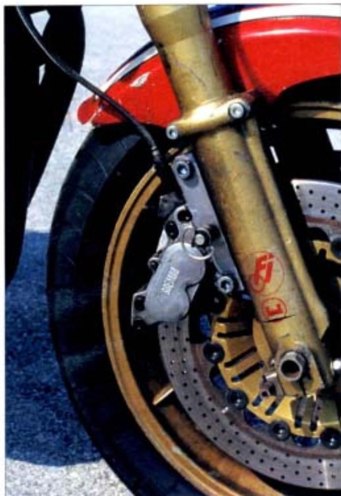
*Ci-dessus à gauche, le frein avant est un double disque à étriers Brembo. Ci-dessus à droite, le système de remplacement des plaquettes prévoit une simple fixation par axe, démontable sans aucun outil.*
