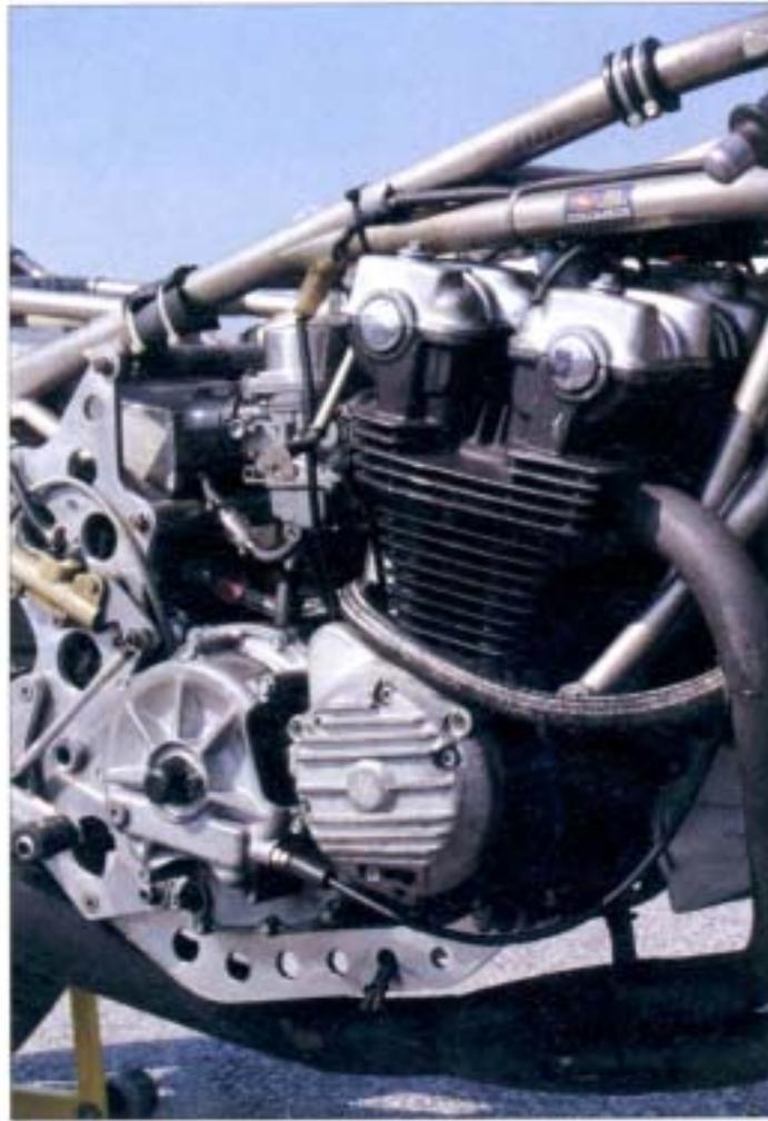
*Le moteur de la 1000 Honda est enchâssé dans la structure mixte de tubes d'acier et de platines en ergal et fut développé par le département Courses de Honda. Il s'agit d'un double arbre à 16 soupapes avec lubrification à carter sec, alimenté par quatre carburateurs Keihin de 36 mm de diamètre. La puissance déclarée est de 130 ch à 9 800 tr/mn. Segale compte parmi les rares préparateurs à avoir pu l'utiliser.*
